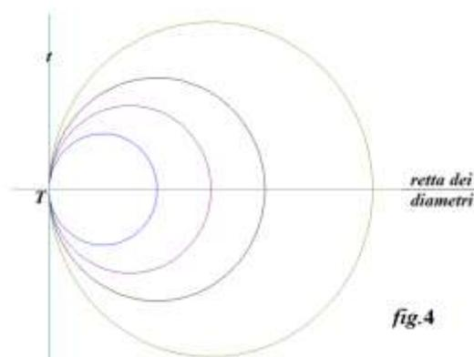
in essa si rileva che aumentando il raggio delle circonferenze tangenti alla retta  $t$  nel punto  $T$ , le circonferenze tendono sempre più a rifilarsi sulla tangente, fino a coincidere con essa quando il raggio è infinito: caso di curva con curvatura nulla ovvero retta.
