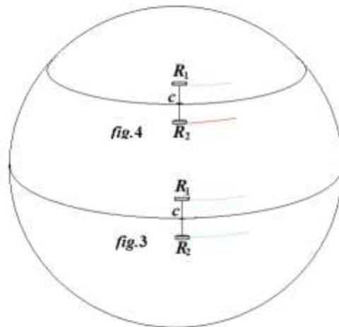
La *fig.4* corrisponde alla *fig.2*, infatti mentre il punto *c* percorre un parallelo, le due ruote percorrono archi diversi: la ruota  $R_1$  percorre il tratto di colore azzurro, minore del tratto di colore rosso percorso dalla ruota  $R_2$ . Infatti la ruota  $R_1$  si muove su un parallelo avente raggio minore del parallelo di *c*, al contrario è per ruota  $R_2$ .
