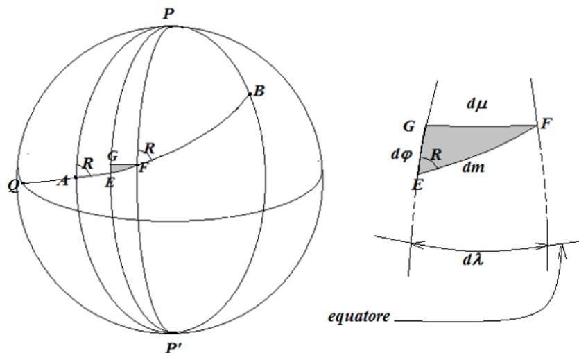
Presi su di essa due punti  $E$  ed  $F$  molto vicini tale da poter considerare infinitesimo l'arco  $EF$  e, tracciato il parallelo  $FG$ , dal triangolo rettangolo  $EFG$ , considerato piano per avere i lati infinitesimi, abbiamo:
